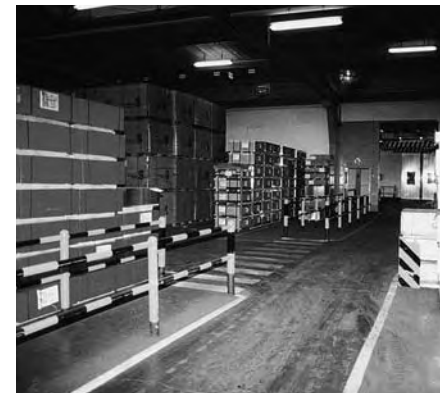
Bild 10: Abgrenzung von Fahr- und Fußwegen
