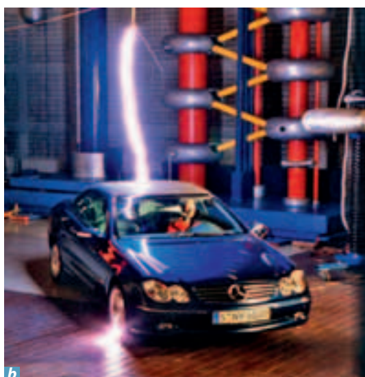
Bild 28 Blitzschutz: a) Blitzschutzanlage b) «Faraday'scher Käfig»
