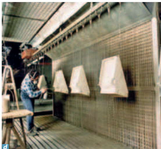
Bild 8 Explosionsgefährdete Bereiche (Bereiche mit explosionsfähiger Atmosphäre): a) Flüssiggas beim Füllen von Flaschen b) Dämpfe beim Umfüllen von Lösemitteln mit niedrigem Flammpunkt c) brennbare Stäube beim Einschütten d) Nebel beim Farbspritzen
