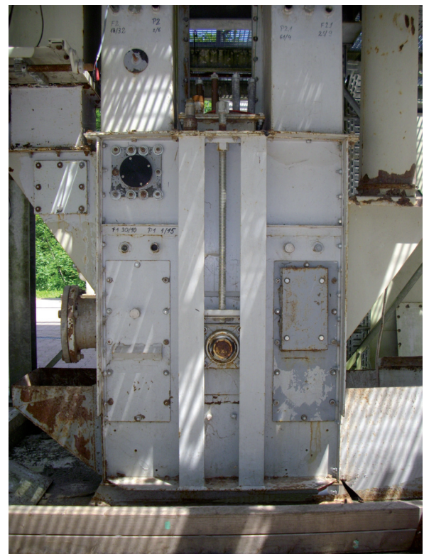
Abbildung 13: Kopf (links) und Fuß eines 15 m hohen Elevators zum Fördern von bis zu 150 \text{ t} \cdot \text{h}^{-1} Getreide.
