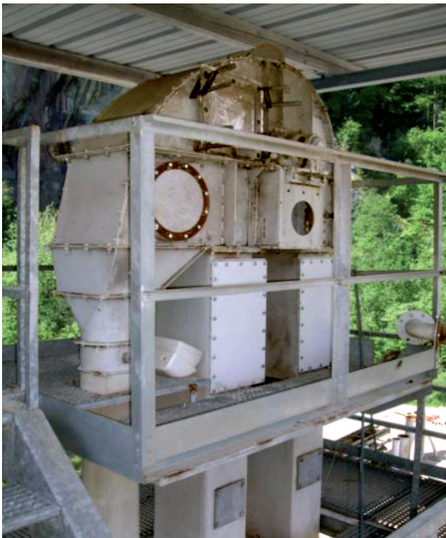
Abbildung 13: Kopf (links) und Fuß eines 15 m hohen Elevators zum Fördern von bis zu 150 \text{ t} \cdot \text{h}^{-1} Getreide.
