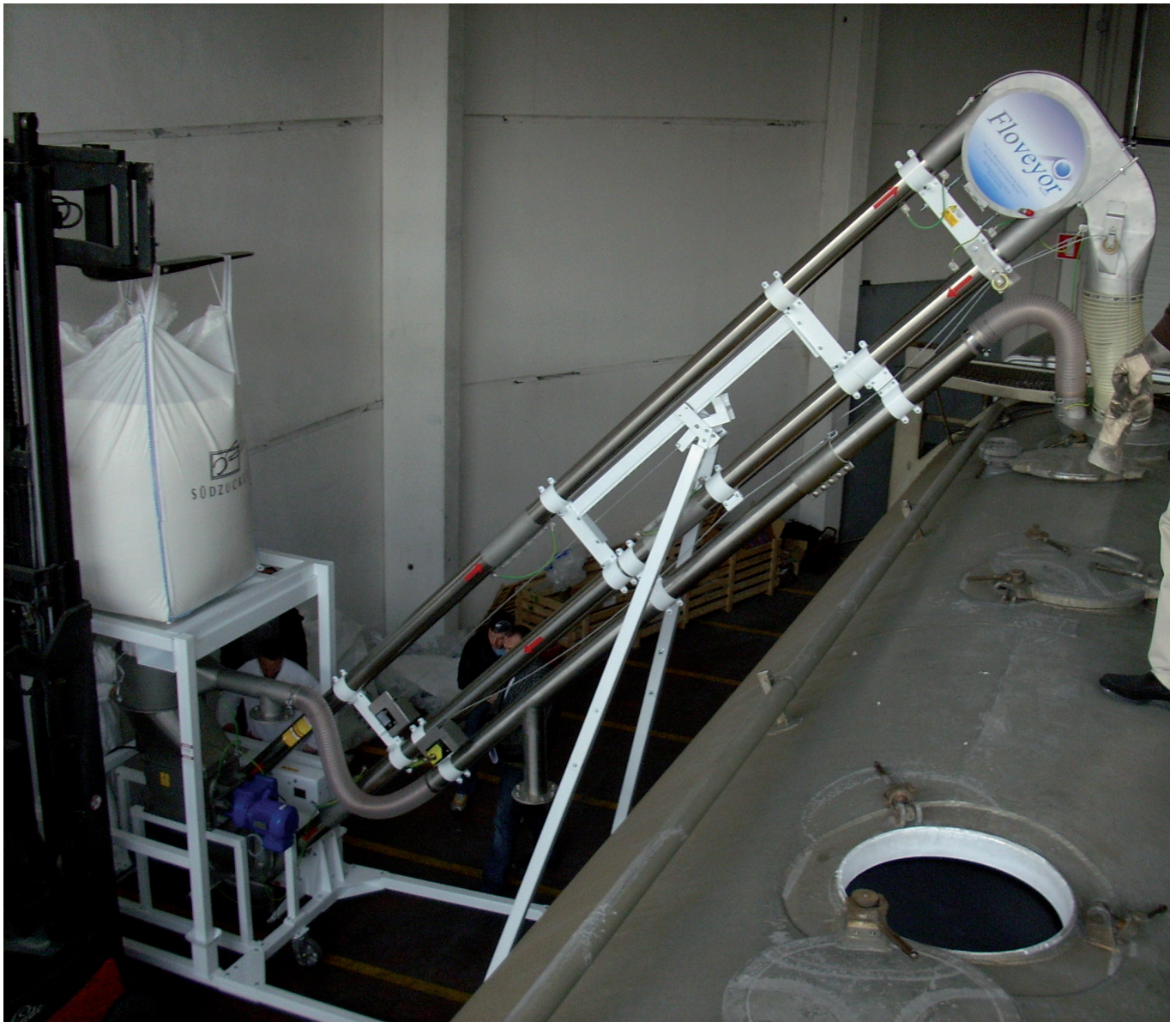
Abbildung 10: Einsatz eines aeromechanischen Förderers zur Beladung eines Silofahrzeuges (Quelle: Gough GmbH Sieb- und Fördertechnik)
