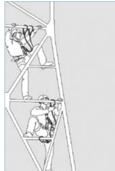
Obr. 18: Příklad přístupu po konstrukci
