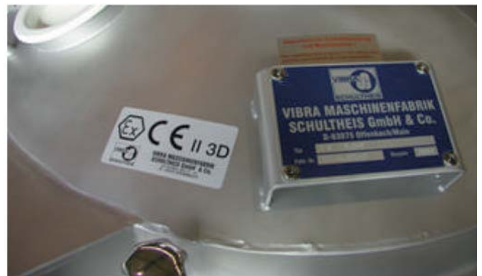
Abbildung 23: Vibrosiebmaschine (links). Der rechte Teil zeigt die Erdungsmaßnahme sowie das Typenschild als Gerät der Kategorie 3D (außen).
