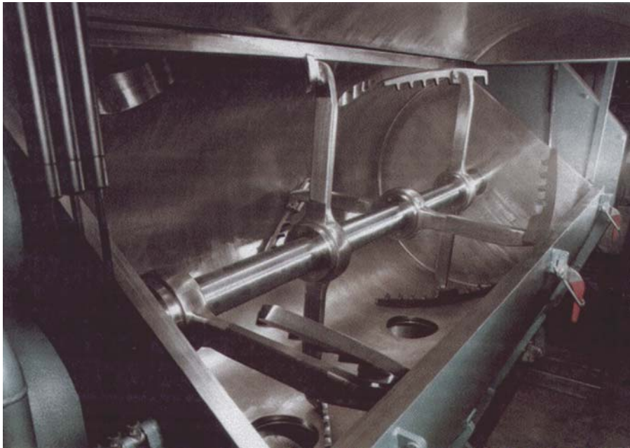
Abbildung 19: Prinzip eines Horizontalmischers (oben). Das Bild links zeigt einen geöffneten Horizontalmischer. [Bild: Prof. Dr.-Ing. Drs. h.c. Manfred H. Pahl, Universität Paderborn]
