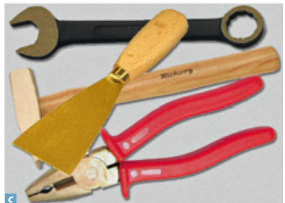
Figure 19 Prévention des étincelles d'origine mécanique: a) humidification / refroidissement lors du meulage b) limitation de la vitesse périphérique c) utilisation d'outils anti-étincelants en cas de présence possible d'une atmosphère explosive comportant des substances à très faible énergie minimale d'inflammation (acétylène, par exemple)
