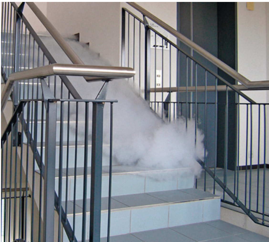
Figure 9 Mode de propagation des vapeurs, brouillards et gaz plus lourds que l'air (nota : les gaz et vapeurs sont généralement invisibles)
