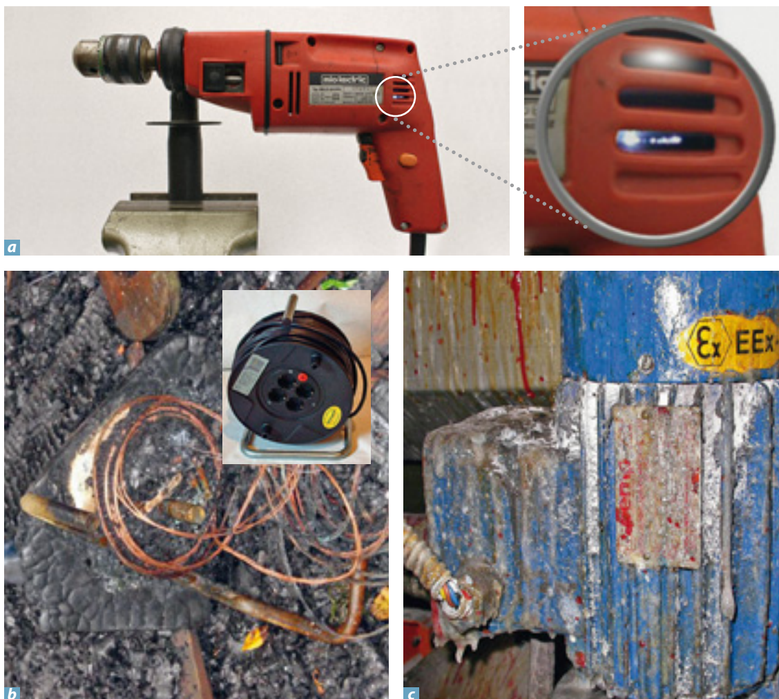
Figure 20 Sources d'inflammation liées à des équipements électriques : a) perceuse présentant des étincelles au niveau du collecteur b) échauffement dans un rouleau de câble c) défaut d'entretien d'équipements électriques utilisables en atmosphère explosive (le matériel ci-dessus porte encore l'ancien marquage Ex)
