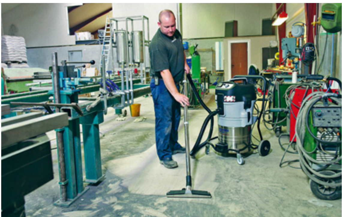
Figure 17 Nettoyage (aspiration des dépôts de poussières)
