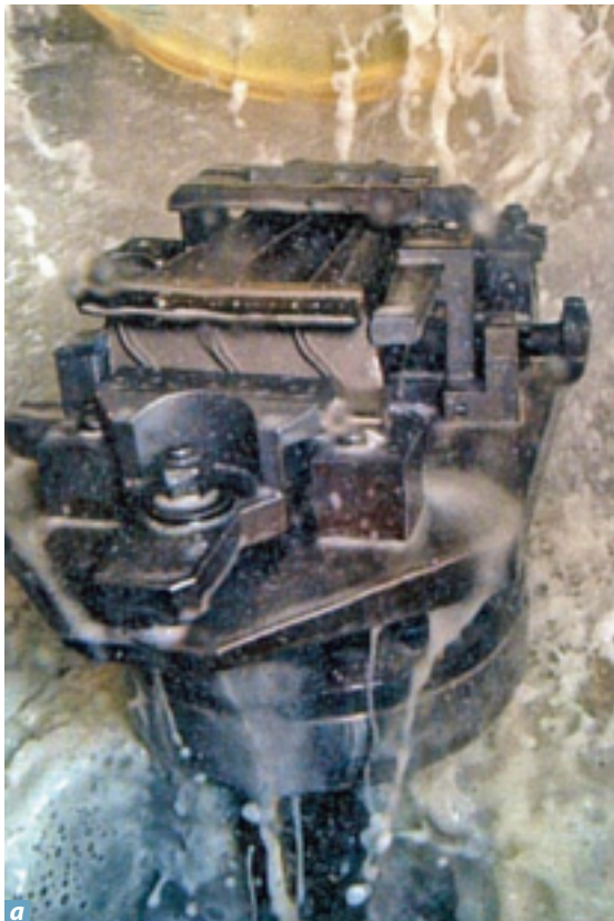
Figure 19 Prévention des étincelles d'origine mécanique: a) humidification / refroidissement lors du meulage b) limitation de la vitesse périphérique c) utilisation d'outils anti-étincelants en cas de présence possible d'une atmosphère explosive comportant des substances à très faible énergie minimale d'inflammation (acétylène, par exemple)
