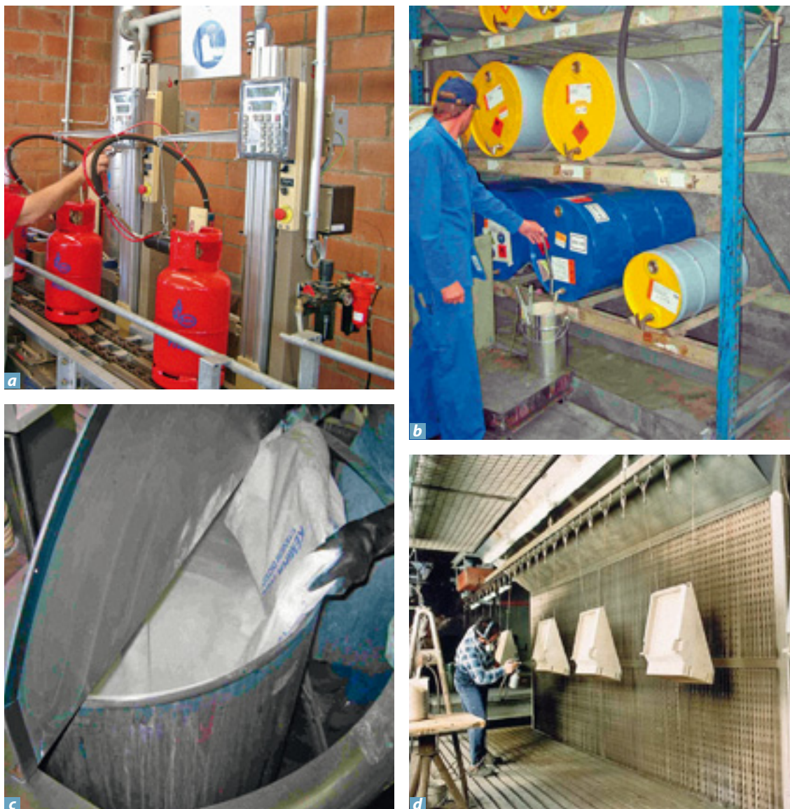
Figure 8 Exemples d'opérations générant une zone à risque d'explosion : a) remplissage de bouteilles de gaz liquéfié b) transvasement de solvants (vapeurs) c) déversement de pigments organiques (poussières) d) pulvérisation de peinture (brouillard)
