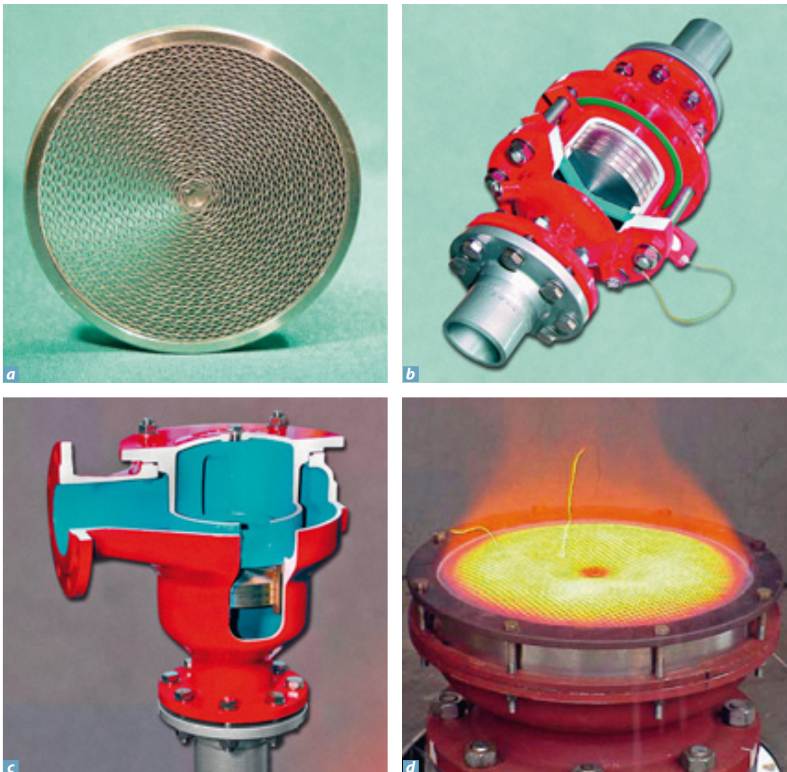
Figure 15 Découplage technique des gaz et vapeurs par des dispositifs arrête-flamme : a ) matrice d'arrête-flamme en métal gaufré b ) arrête-flamme anti-déflagration (maquette, coupe) c ) arrête-flamme anti-détonation (maquette, coupe) d ) arrête-flamme en bout de ligne pour brûlage en continu
