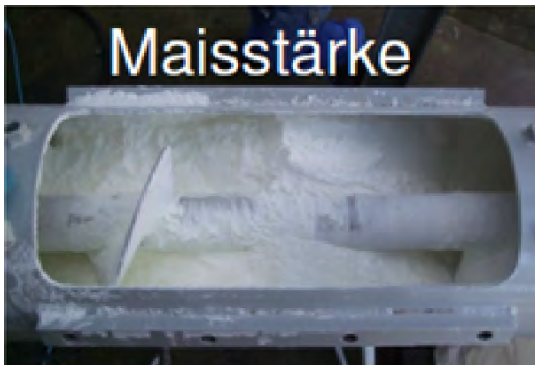
Bild 43: Zustand des Produktpfropfens nach dem Leerfahren der Schnecke für die drei Produkte Weizenmehl (teilweise Pfropfen), Maisstärke (kein Pfropfen) und Cellulose (voller Pfropfen), (Prof. Siegfried Radandt)
