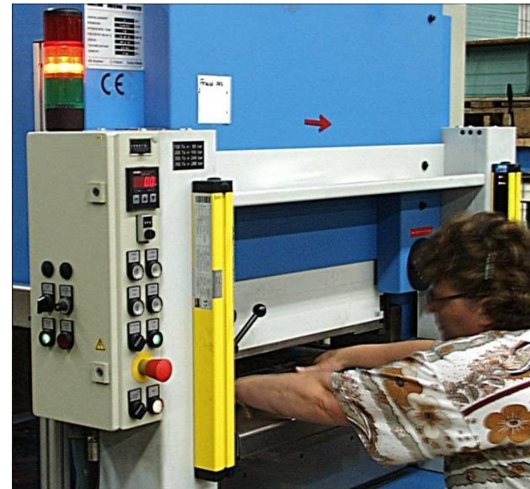
Une presse protégée par une barrière lumineuse.
